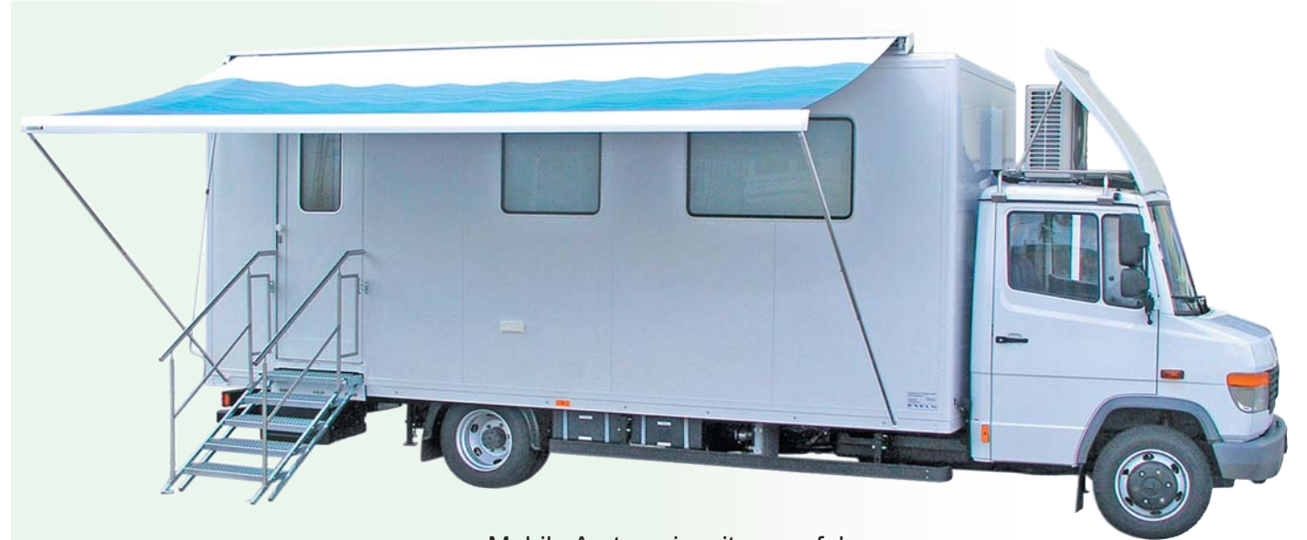
Mobile Arztpraxis mit ausgefahrener Markise und Zugangstreppe mit aufgestecktem Geländer
